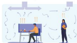
Ventilatie met luchttoevoer en -afvoer in plafond
