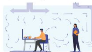
Ventilatie met luchttoevoer in het plafond, luchtafvoer onderin de ruimte
