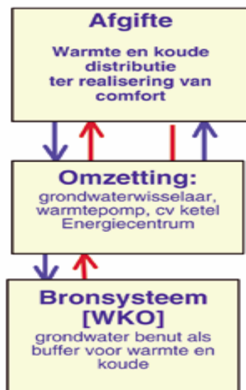
Figuur 3 Weergave klimaatinstallatie met onderdeel bodemenergiesysteem
