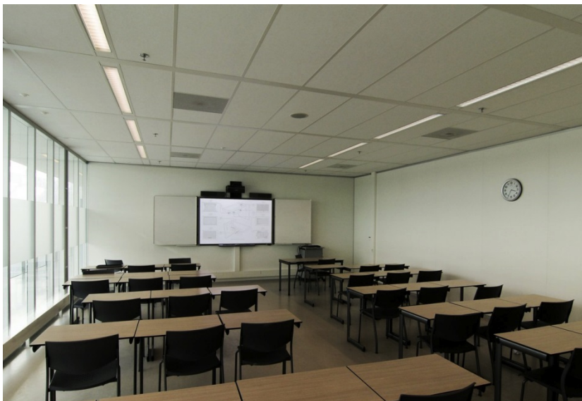
Foto 2: De basis van de akoestiek van een schoollokaal is een fikse hoeveelheid absorptie. Een goede spraakverstaanbaarheid wordt bereikt met een absorberend oppervlak ter grootte van het plafondoppervlak. Maar dan moeten er wel absorberende leerlingen aanwezig zijn. In de getoonde situatie is wel degelijk een enigszins storende galm hoorbaar doordat de evenwijdige wanden tot een "horizontaal galmveld" leiden. Daardoor is ook wat flutter hoorbaar.
