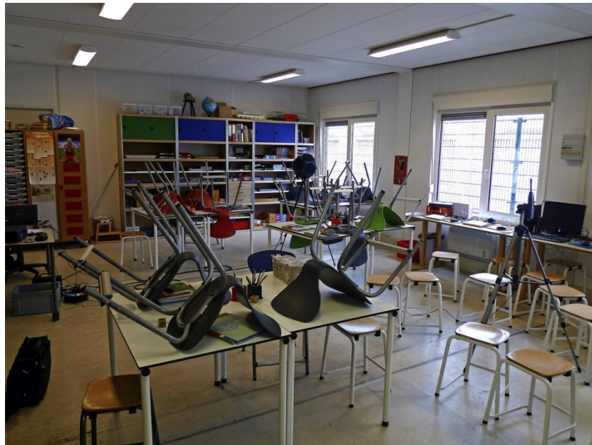
Foto 3: Of veel meubilair en kasten het beeld verfraaien staat ter discussie. Maar de nagalmtijd wordt nog wel degelijk verlaagd t.o.v. de voorgaande foto doordat het geluid wordt verstrooid en de open kasten ook nog wat absorptie toevoegen. Op een paar meter afstand van een spreker is de spraakverstaanbaarheid "uitstekend"; achter in de klas vinden we in dit soort situaties een spraakverstaanbaarheid op de grens van "goed" en uitstekend.
